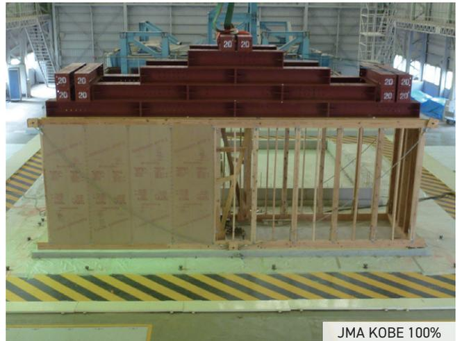
■制震テープを使用した振動実験
