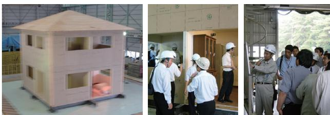
新築住宅の固有周期は0.1～0.2秒と短く、比較的地震の影響を受けにくいのですが、度重なる地震によって損傷（接合部の緩み等）が進み、地震の度に変位はドンドン大きくなってゆきます。一方、制震テープ工法の住宅の場合は、繰り返しの地震を受けてもほぼ同じ変位を保ちます。
