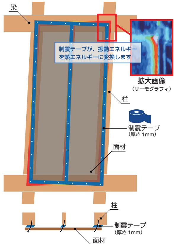
制震テープは、地震の揺れに抵抗して力強く粘り建物の変形を抑えます。建物は耐震性能を保ち続け、繰り返しの地震に強い「制震住宅」となります。
