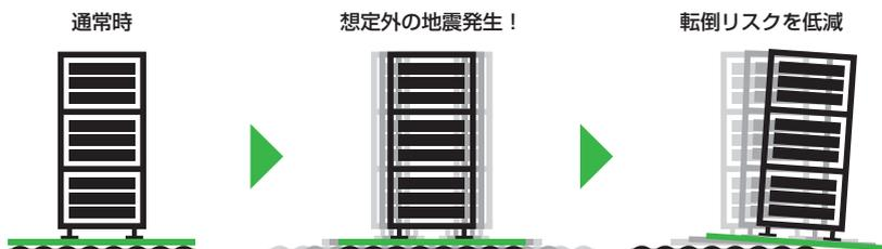
ミュソレーターは、製品自体に可動限界はなく、可動範囲 (=安全性能) を自由に計画可能。万一、計画した可動範囲を超えても、落差はわずか 1.3mm のため転倒・破損リスクは最小限に抑えられます。
