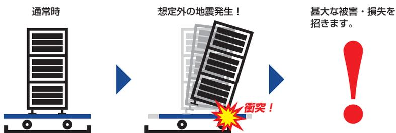
一般的な免震装置は ±200 ~ 300mm と可動範囲が限られているため、可動限界を超える揺れ幅の地震によって装置がストッパーに衝突し、搭載物の転倒・落下・破損のリスクは避けられません。
