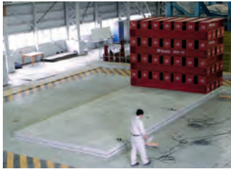
偏在荷重による揺れ振動実験
